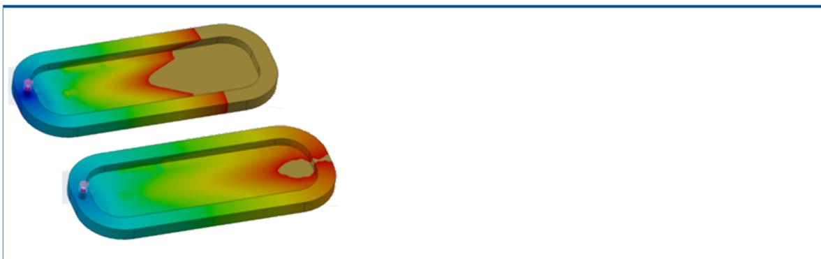
Formation de lignes de soudure due à l'effet de circuit
