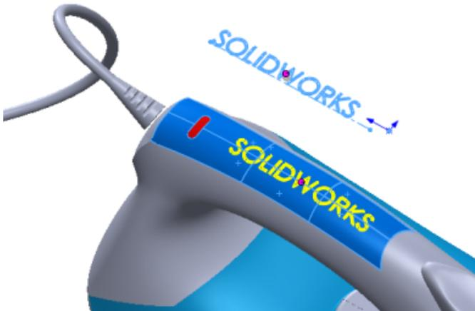
6. Dans le PropertyManager, sous **Paramètres d'enroulement**, définissez l'**Epaisseur** sur 2 mm et cliquez sur
